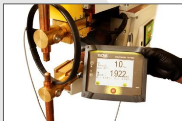
Pomiar prądu zgrzewania
